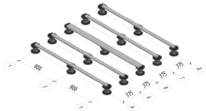
Рис. 3.2. Схема расположения регулируемых опор при использовании алюминиевой лаги 75
