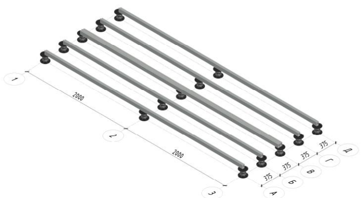
Рис. 3.4. Схема расположения регулируемых опор при использовании стальной профильной трубы 60x40x2 мм
