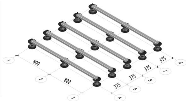
Рис. 3.1. Схема расположения регулируемых опор при использовании алюминиевой лаги 69
