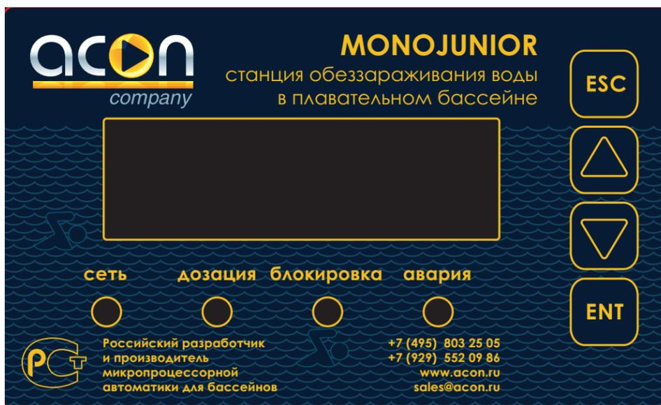
Двухстрочный жидкокристаллический дисплей для настройки и отображения рабочих и установочных параметров
